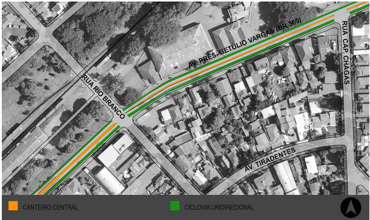
Figura 94 – Proposta de intervenção na avenida Getúlio Vargas com canteiro central e ciclovia unidirecional.
