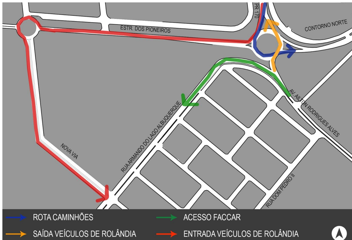
Figura 75 – Proposta final de readequação da rotatória.
