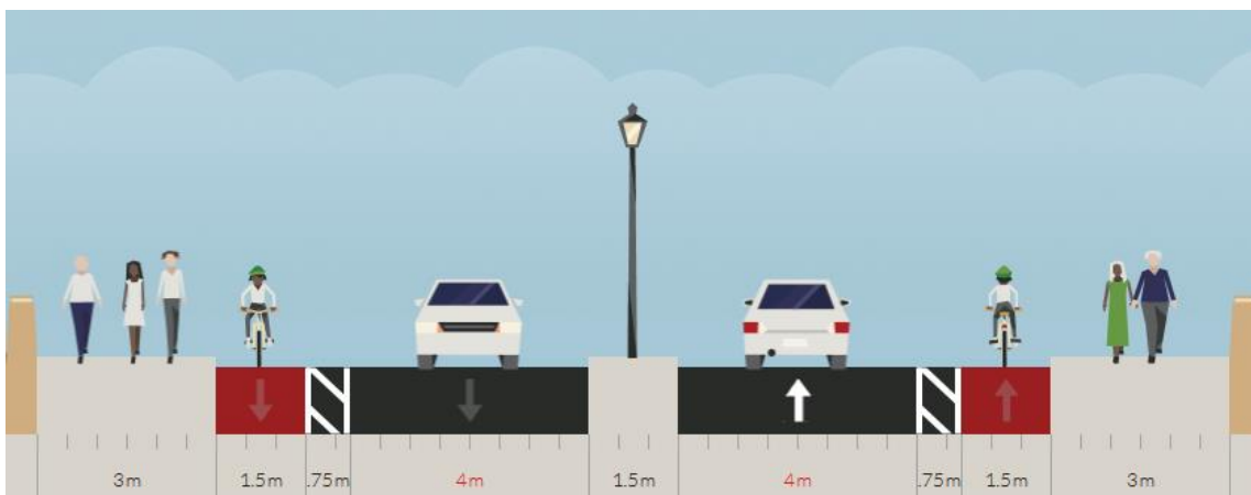
Figura 108 – Perfil proposto para a avenida Aylton Rodrigues Alves no trecho de maior largura (Caixa de 20 m).
