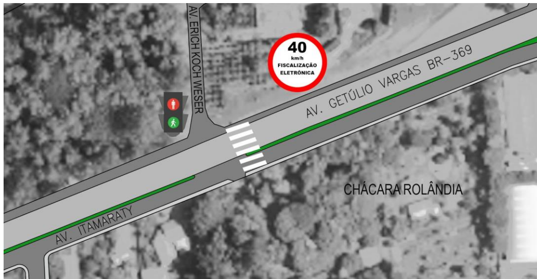
Figura 71 – Proposta de fiscalização eletrônica na travessia da Av. Pres. Getúlio Vargas com Av. Erich Koch Weser.
