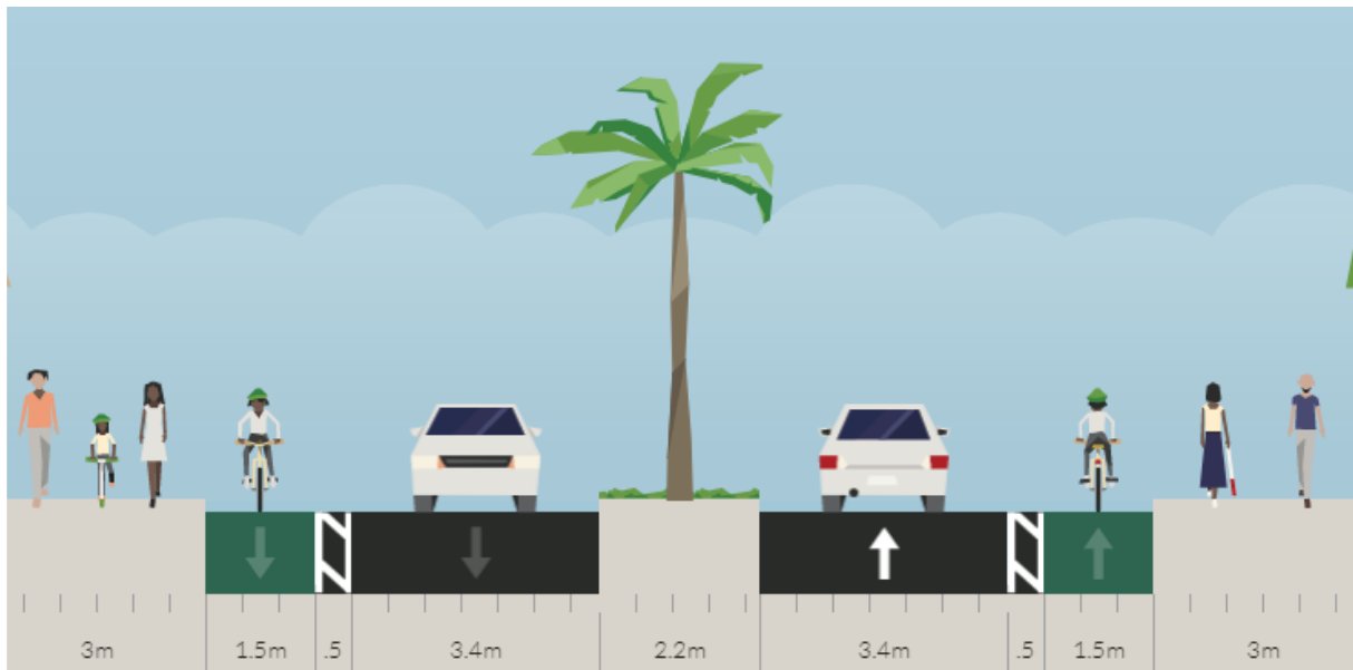
Figura 99 – Perfil proposto para Av. Geúlio Vargas sem faixa de estacionamento.
