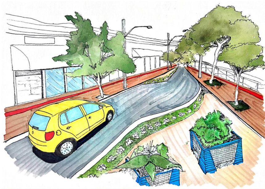
Figura 168 – Proposta de chicana para diminuir a velocidade do automóvel.
