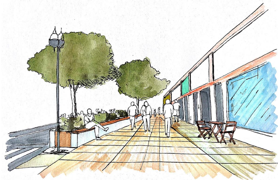
Figura 137 – Calçada com mobiliário urbano na faixa de acesso e faixa de serviço.
