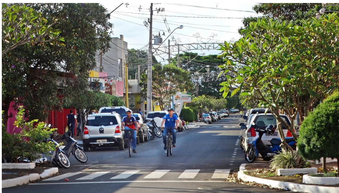
Figura 171 – Extensão de esquina na Rua Sagaragi.
